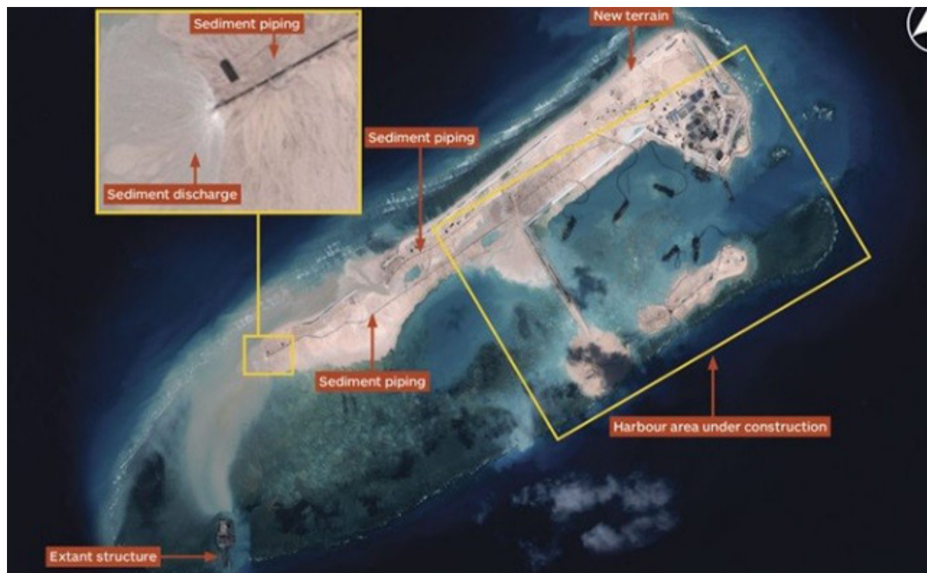
Ảnh 5: Hoạt động xây đảo của Trung Quốc bắt đầu diễn ra từ tháng 8 năm 2014. Ảnh vệ tinh Bãi Chữ Thập ngày 14 tháng 11 năm 2014 cho thấy các hoạt động xây đảo của Trung Quốc, với nhiều tàu nạo vét đang hoạt động cùng một lúc, nạo vét bùn từ đáy biển rồi đổ lên trên bãi thông qua một mạng lưới ống dẫn, giúp tạo ra địa hình một cách nhanh chóng. Nguồn ảnh: © CNES 2014, Distribution Airbus DS / Spot Image / IHS.
