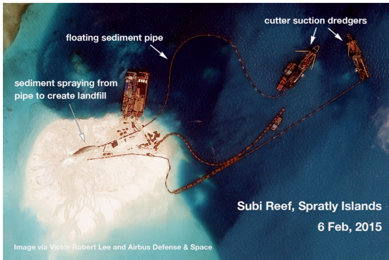
Ảnh 59: Ảnh vệ tinh cận cảnh hoạt động nạo vét và xây đảo nhân tạo trên bãi Xu Bi ngày 6 tháng 2 năm 2015. Nguồn ảnh: Victor Robert Lee và Airbus Defense & Space.
